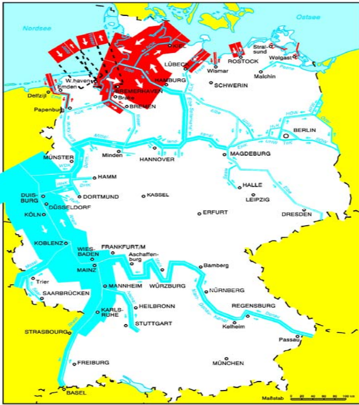
Güterverkehrsdichte in Mill t (km / Länge der Wasserstraße in km) bis 1 Mill t: [light blue] über 1 Mill t: [dark blue] Binnenschifffahrt: [light blue] Seeschifffahrt*: [red] *berechnet auf der Grundlage der Umschlagzahlen der Seehäfen - außer Nord Quelle: Statistisches Bundesamt, Wiesbaden Kartografie: Sonderstelle für Vermessungswesen beim Wasser- und Schifffahrtsamt Regensburg
