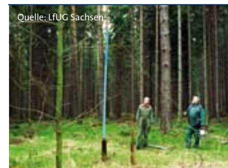
Wasserstandsmessung an einer Grundwassermessstelle in einem artesischen Grundwasserleiter
