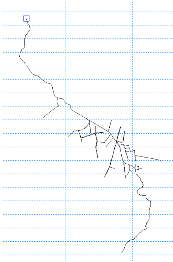
Abbildung 6-6: Für die Ermittlung des Speichervolumen berücksichtigte Nebengewässer und Entwässerungsgräben entlang der Wulbeck (die Wulbeck wurde nur zur besseren Orientierung aufgenommen, in der Bilanzierung jedoch nicht berücksichtigt)
