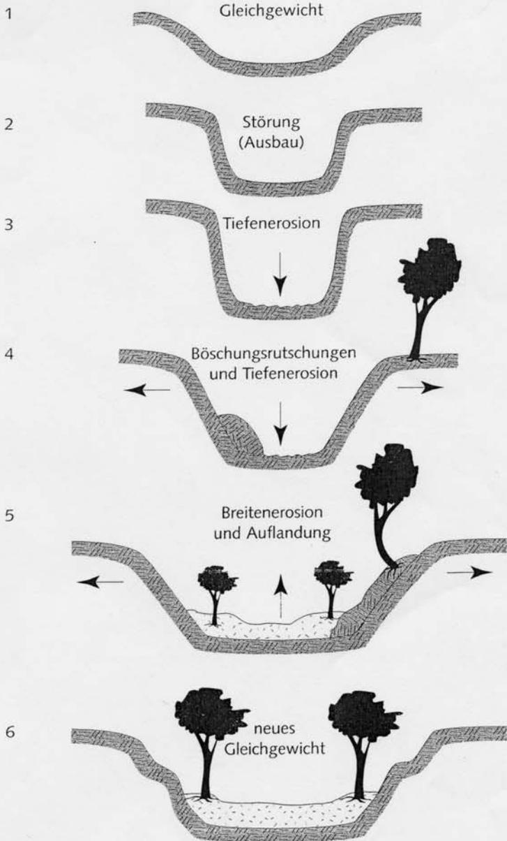
▲ Unterschiedliche Entwicklungsphasen von Erosionsgewässern
