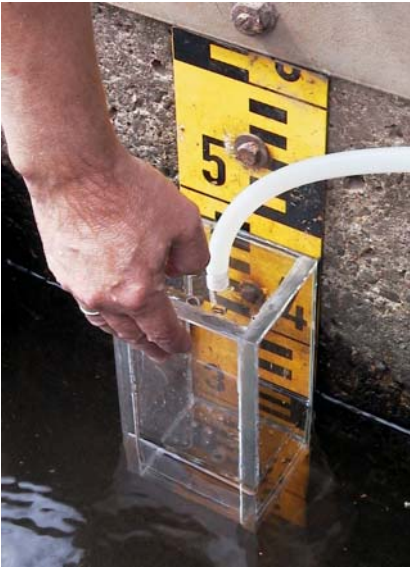
Abbildung 1: Plexiglasabdeckung zur Beruhigung des Wasserspiegels an der Pegellatte
