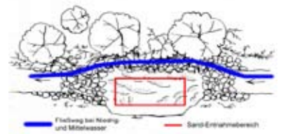
(6) Schema eines Sandfangs: Linie = Bachlauf bei Mittel- und Niedrigwasser; Kasten = Sandentnahmebereich
