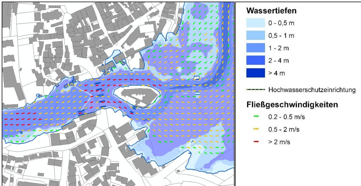
**Abbildung 17: Beispielhafte Darstellung der Fließgeschwindigkeiten in einer Hochwassergefahrenkarte (Ausschnitt, Fachdaten: Bayerisches Landesamt für Umwelt; Geobasisdaten: DTK25, © Bayerische Vermessungsverwaltung 2010)**
