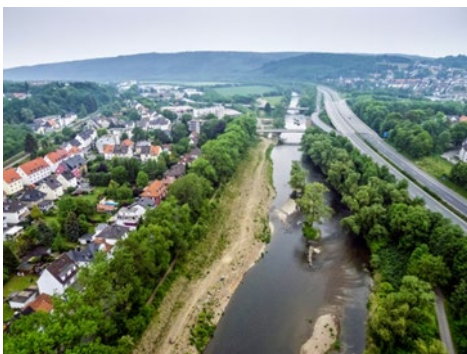
Abbildung 27: Ruhr bei Arnsberg; im Vordergrund ein renaturierter Abschnitt, im Hintergrund ein nicht renaturierter Abschnitt. Foto: G. Bockwinkel, MKULNV NRW
