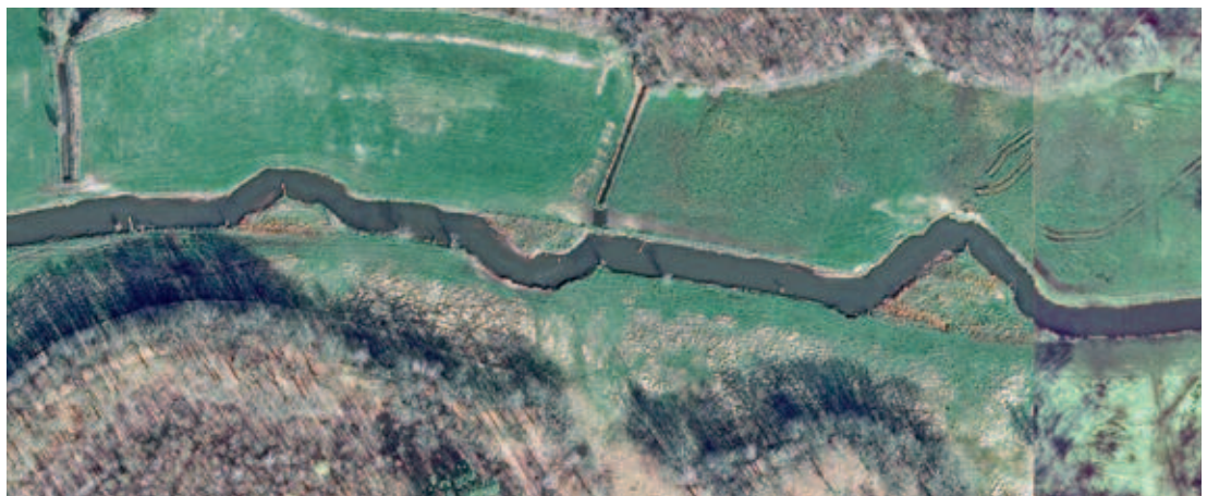
Luftbildaufnahme einer Serie von drei Laufverschwenkungen. © DOP: GeoBasis-DE/LVermGeo SH
