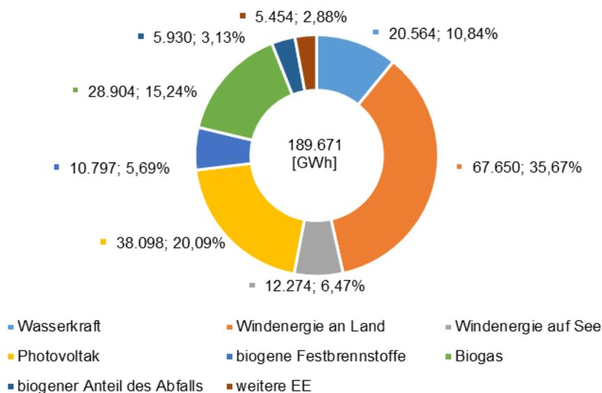
Abbildung 3-36: Bruttostromerzeugung erneuerbarer Energieträger (Stand 2018; BMWi, 2019)
