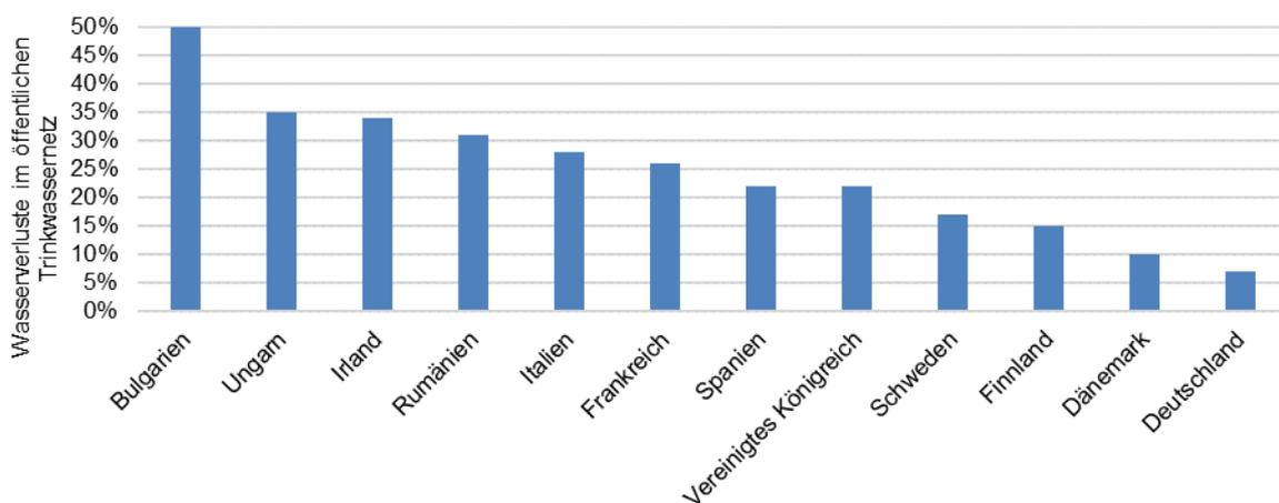
**Abbildung 4-6: Wasserverluste im öffentlichen Trinkwassernetz als wichtigster Indikator für Qualität des Netzes und Versorgungssicherheit im internationalen Vergleich<sup>18</sup> (Wasserverluste in ausgewählten europäischen Ländern (in Prozent vom Bruttowasseraufkommen), 2008)**
