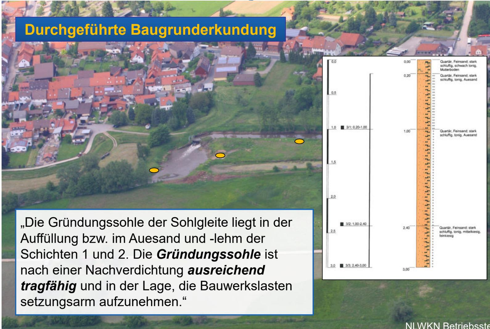
„Die Gründungssohle der Sohlgleite liegt in der Auffüllung bzw. im Auesand und -lehm der Schichten 1 und 2. Die **Gründungssohle** ist nach einer Nachverdichtung **ausreichend tragfähig** und in der Lage, die Bauwerkslasten setzungsarm aufzunehmen.“
