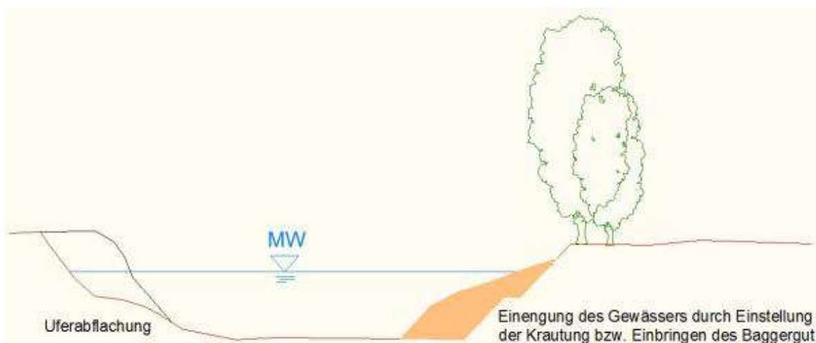
Abbildung 7-9: Maßnahmenvariante 1 - Abflachung der Böschung
