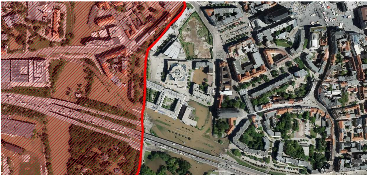
Abbildung 4: Hochwasser der Saale 2013 im Stadtgebiet Halle (S.) mit der Abgrenzung der bisher ermittelten Flächen eines HQextrem (rot schraffiert) und den tatsächlich überschwemmten Flächen
