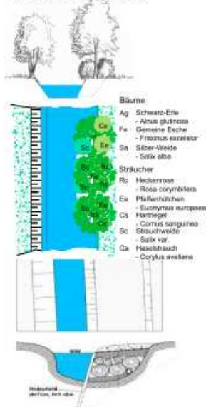
Querprofileinengung mittels Totholzverbau / -Bepflanzung
