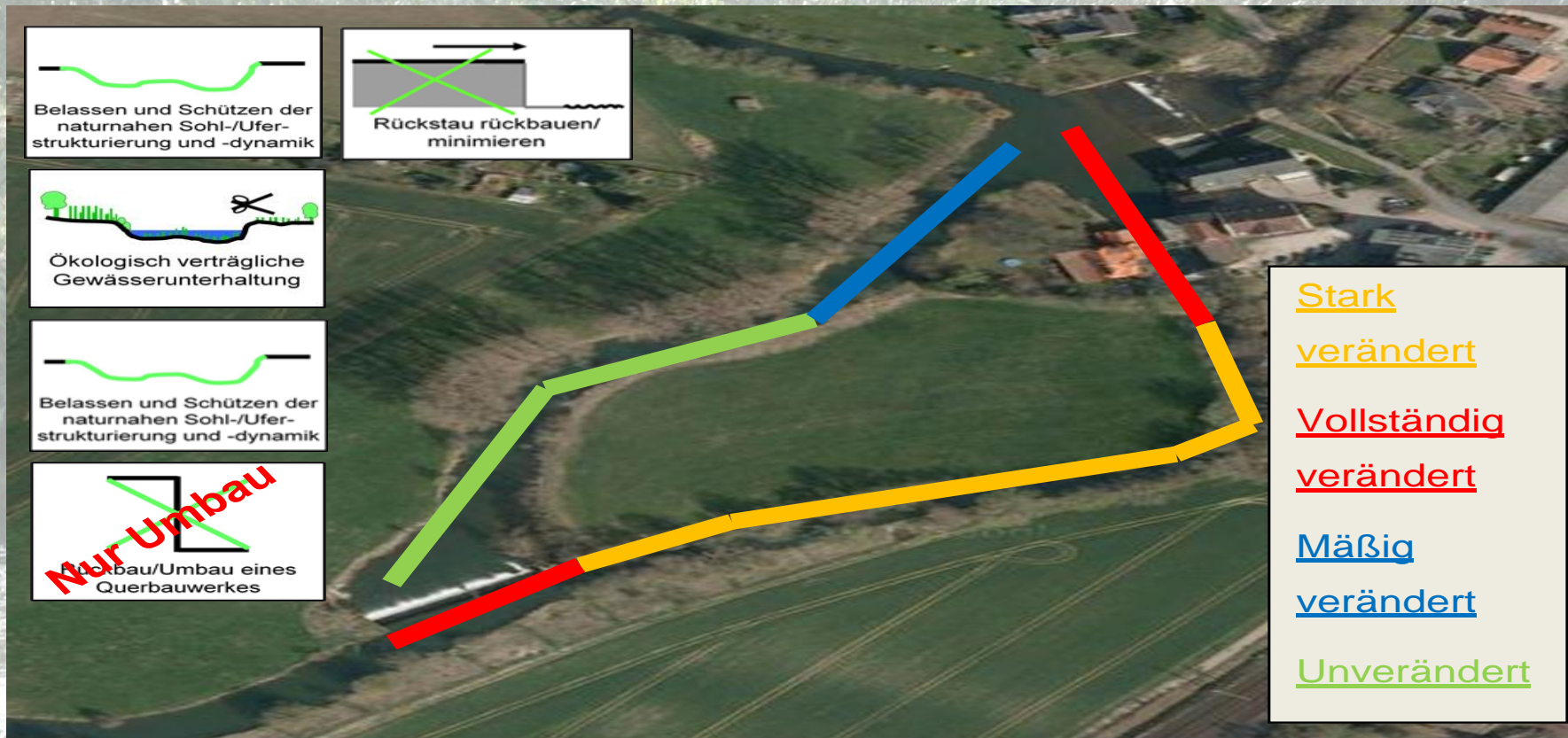
Abbildung 7.22: Darstellung der Eingriffsgrade nach dem Strahlwirkungskonzept vom Anfang des Betrachtungsabschnittes bis zum zweiten Wehr mit Darstellung der möglichen Maßnahmen durch Piktogramme gemäß Strahlwirkungskonzept NRW (Bild: Google Maps vom 13.10.2011)
