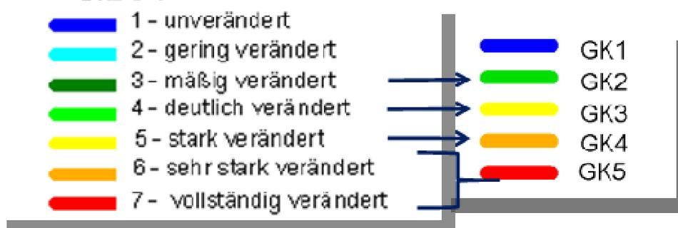
Abbildung 17: Zusammenfassung der 7 Strukturgüteklassen in eine 5-stufige Güteklasse-Skala<sup>81</sup>
