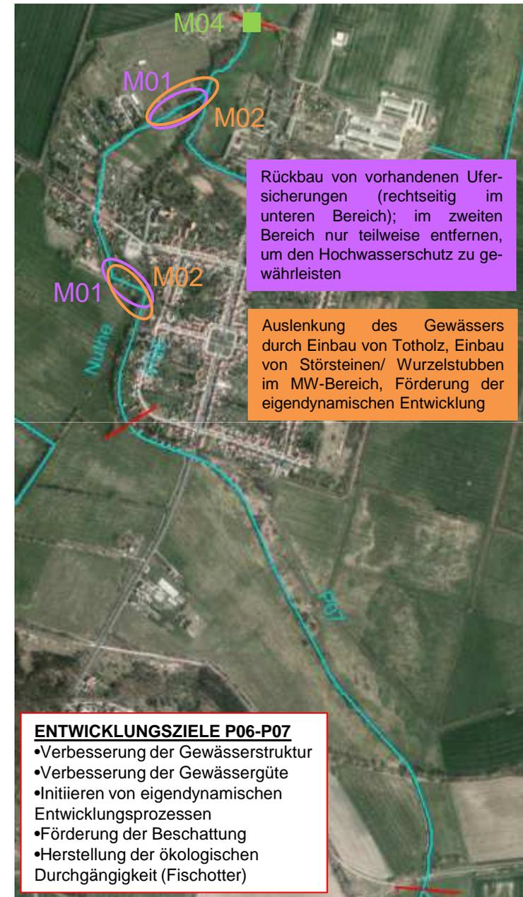
Rückbau von vorhandenen Ufersicherungen (rechtseitig im unteren Bereich); im zweiten Bereich nur teilweise entfernen, um den Hochwasserschutz zu gewährleisten
