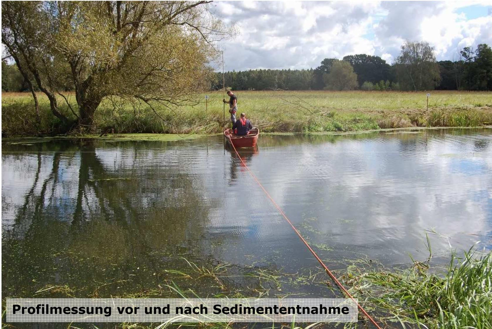
**Profilmessung vor und nach Sedimententnahme**
