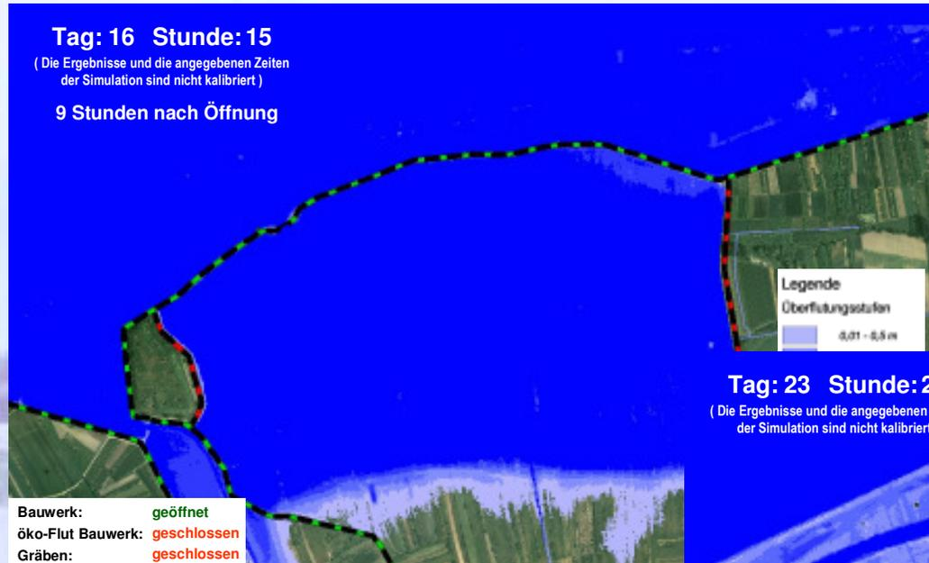
Polder ist 8 Stunden nach Öffnung des Ein- und Auslassbauwerks gefüllt
