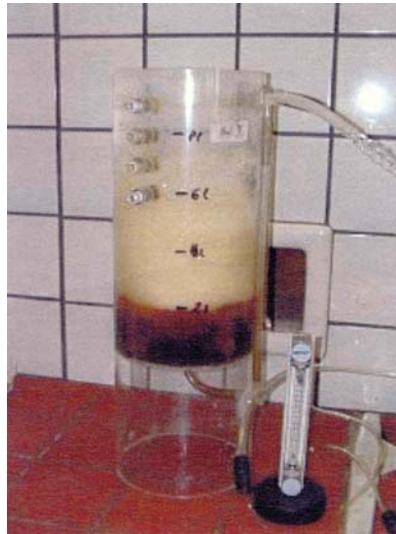
Abbildung 1: Versuchsapparatur zur Überprüfung der TOC-Abnahme im Wasser und der VOC-Wiederfindungsrate im Abgasstrom
