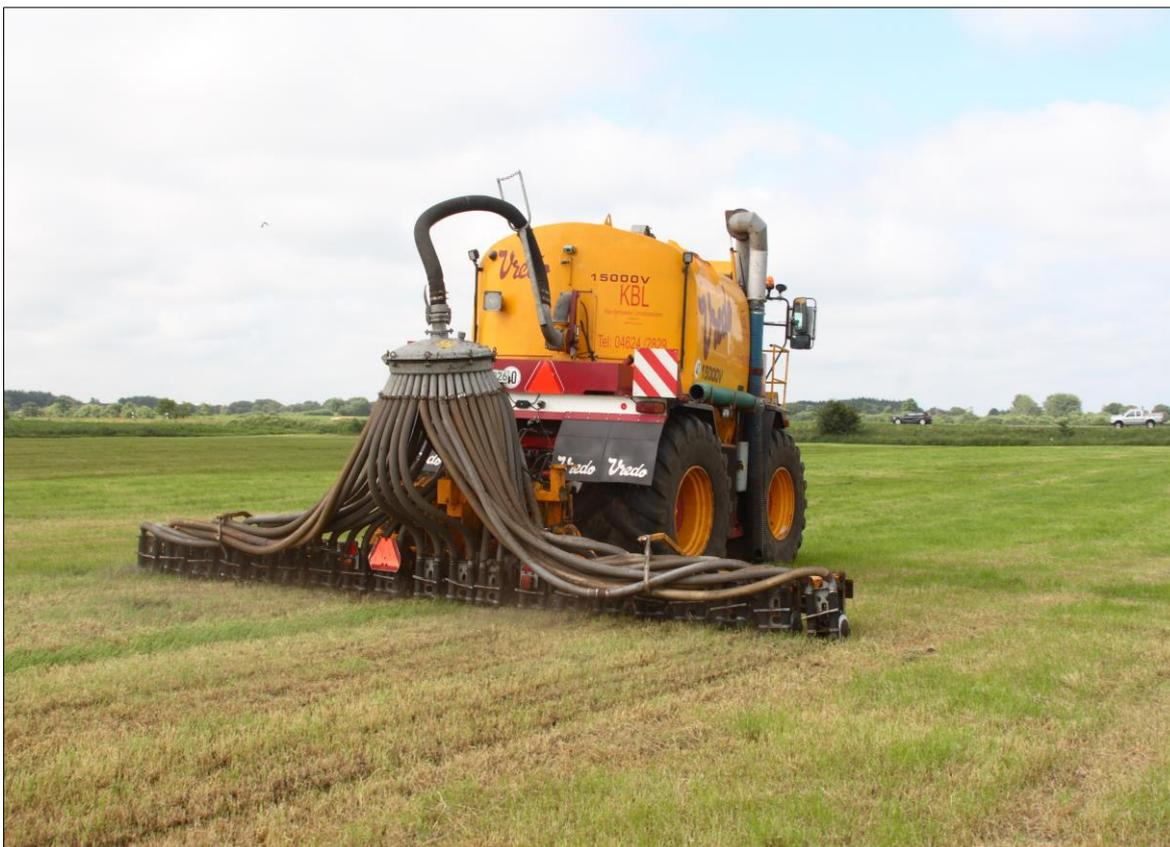
Abb. 25: Angewandte Schlitztechnik bei der Gülleausbringung (Foto: Dr. Steinmann)
