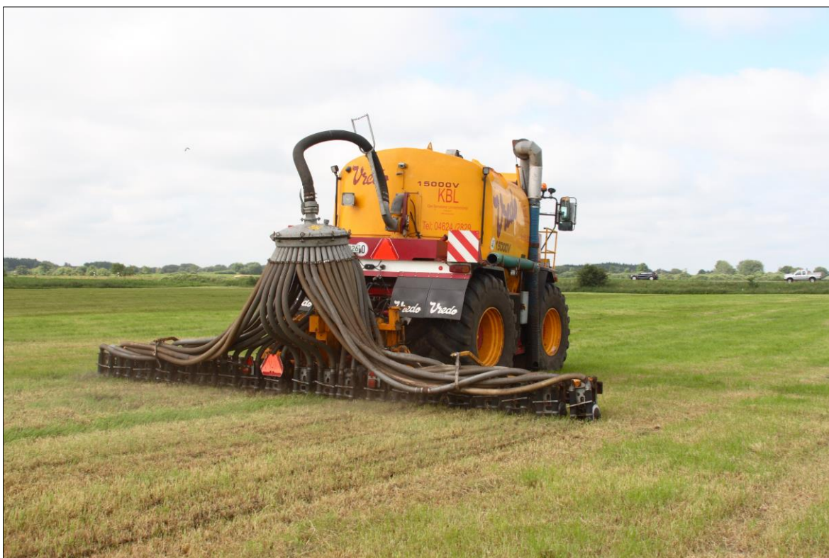
Abb. 17: Angewandte Schlitztechnik bei der Gülleausbringung (Foto: Dr. Steinmann)
