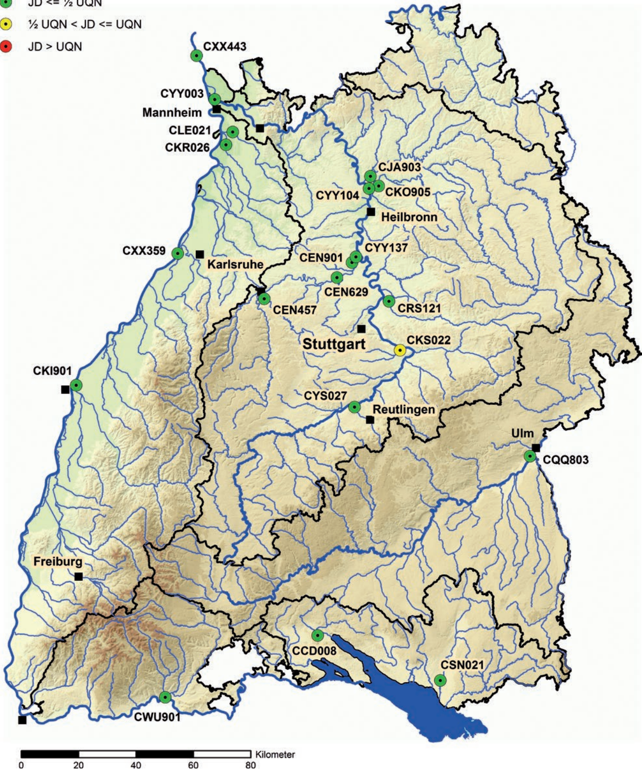
Abbildung 6.4: Beurteilung der Gewässerbelastung für Terbutryn auf Basis der UQN lt. Richtlinie 2013/39/EU von 0,065 \mu\text{g/L} im Jahresdurchschnitt (JD) von Mai 2012 bis April 2013
