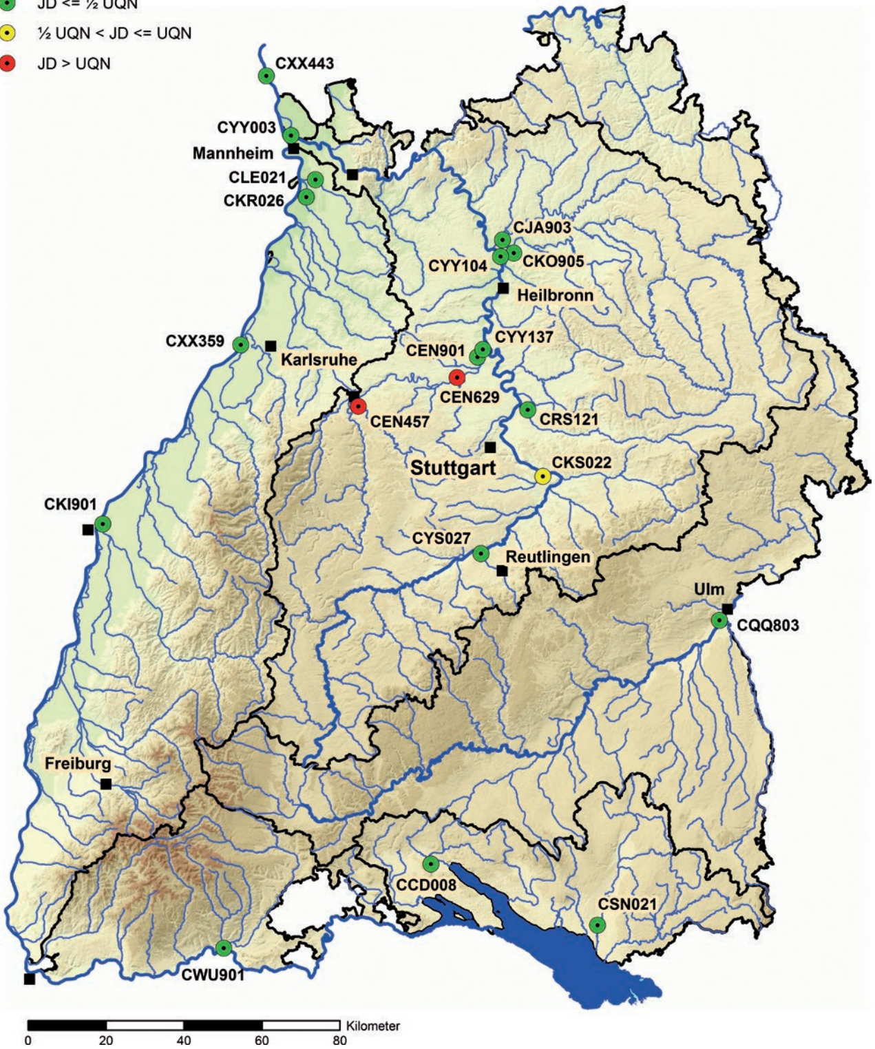
Abbildung 6.3: Beurteilung der Gewässerbelastung für MCP (Mecoprop) auf Basis der OGewV -UQN von 0,1 µg/L im Jahresdurchschnitt (JD) von Mai 2012 bis April 2013
