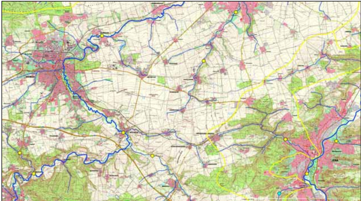
Abbildung 5.7 Beispiel 6: Geringe Messstellendichte in der Region, die meisten Messstellen wurden zudem als anthropogen beeinflusst eingestuft (gelb), da sie meist im Abstrom von Siedlungen liegen
