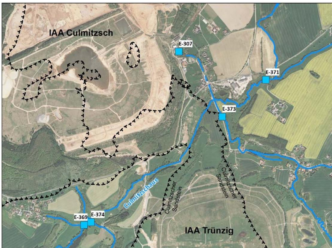
Abbildung 6 Verbreitung der Zechsteinbrücke sowie Lage der Oberflächenwasser-Messstellen im Bereich der Culmitzschau
