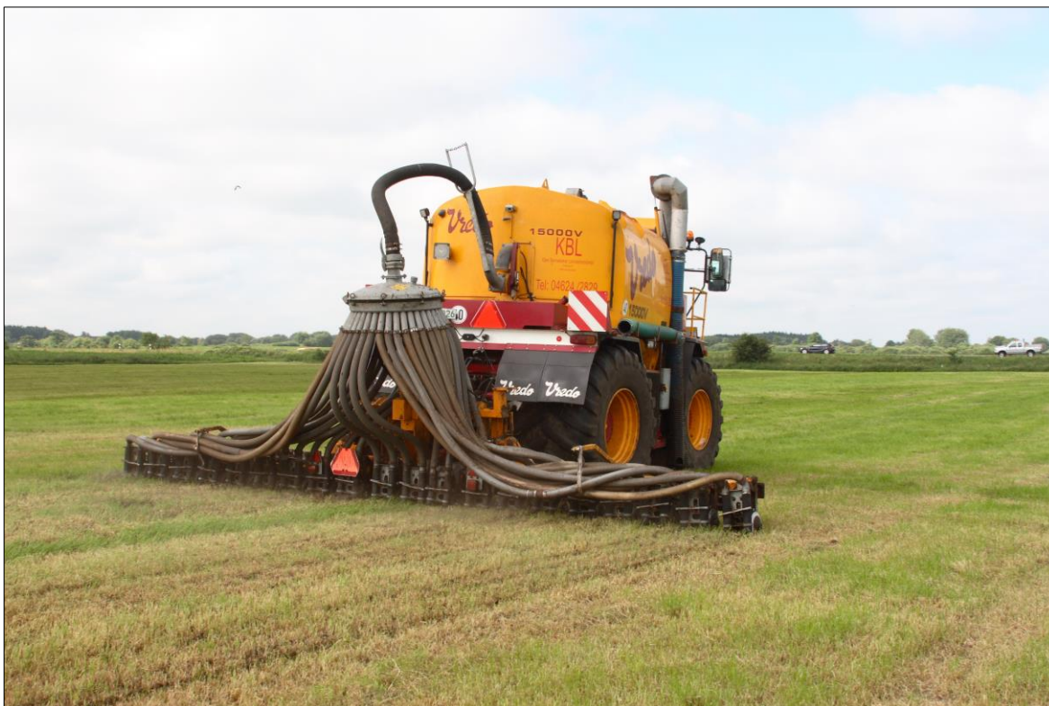
Abb. 25: Angewandte Schlitztechnik bei der Gülleausbringung (Foto: Dr. Steinmann)
