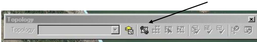
Abbildung 0-7: → **Construct Features** der „Topology Toolbar“
