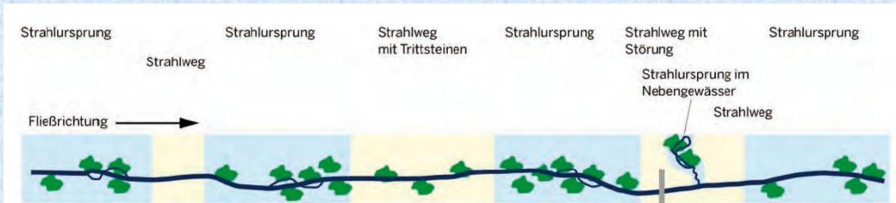
Abbildung 2: Schematische Darstellung der Funktionselemente des Strahlwirkungs- und Trittsteinkonzeptes (nach DRL 2008)
