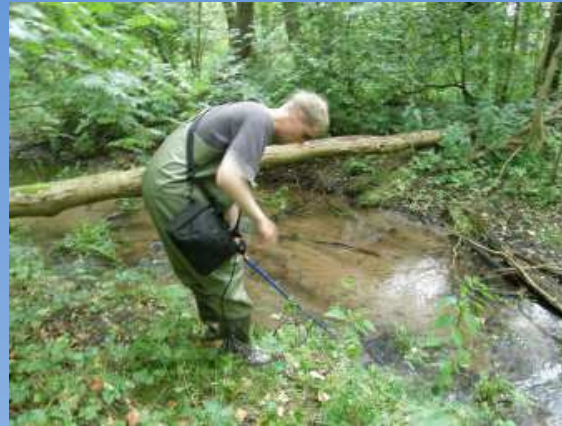
Untersuchung der Fließgeschwindigkeiten im Stromstrich bei Niedrigwasser (MQ August +/- 20 %)
